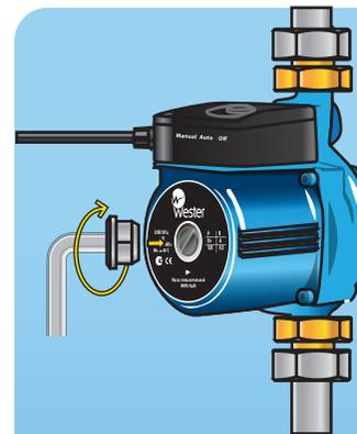
③ Проверьте отсутствие воздуха в воде. После чего заверните пробку.
