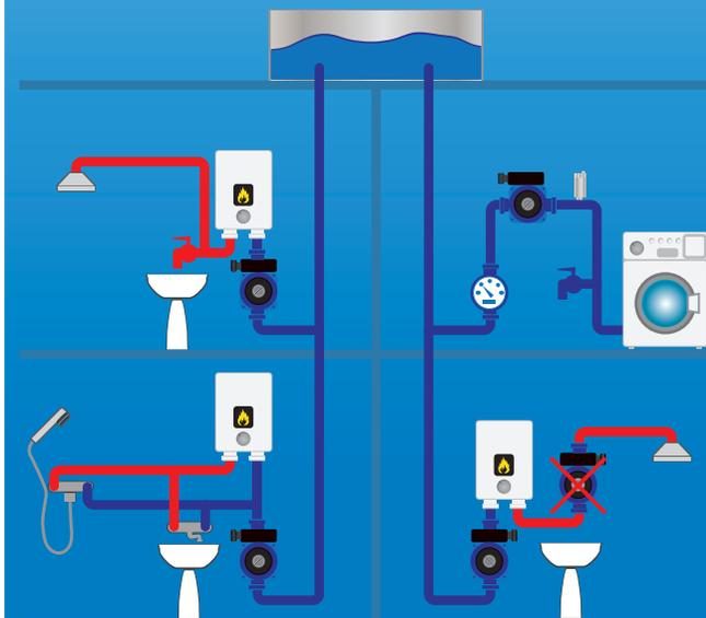
Внимание: Не устанавливать насос в систему горячего водоснабжения
